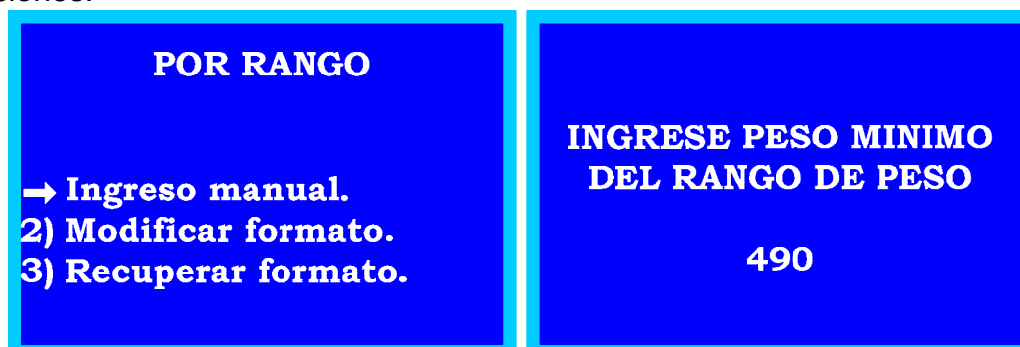
Figura 2.2: Muestra el acceso al modo por rango e ingreso manual de parámetros.
