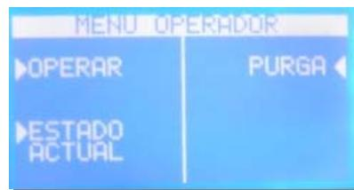
PURGA permite realizar un llenado de todo el circuito de dosificación de YT Wine® con gas, de manera de desplazar cualquier remanente de aire de él, con el fin de asegurar que las aplicaciones sean precisas.
